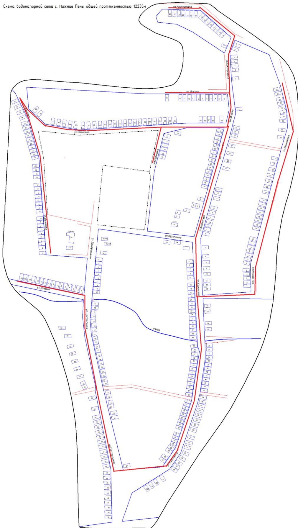
Рисунок 4 Схема водоснабжения с. Нижние Пены
